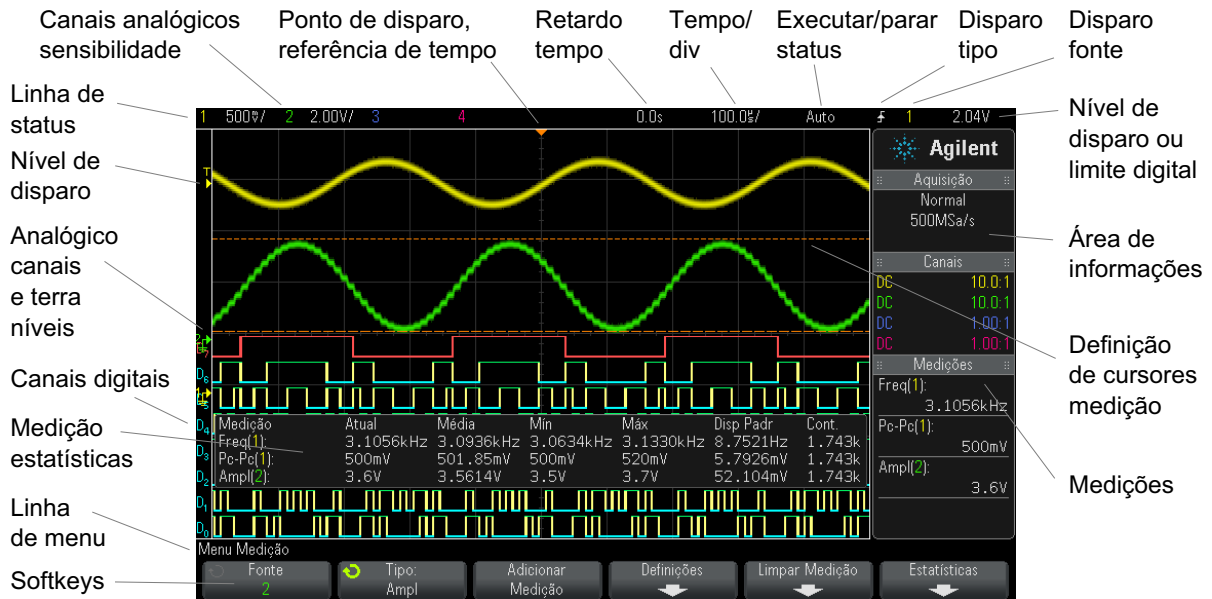
Figura 1 Interpretação da tela do osciloscópio
